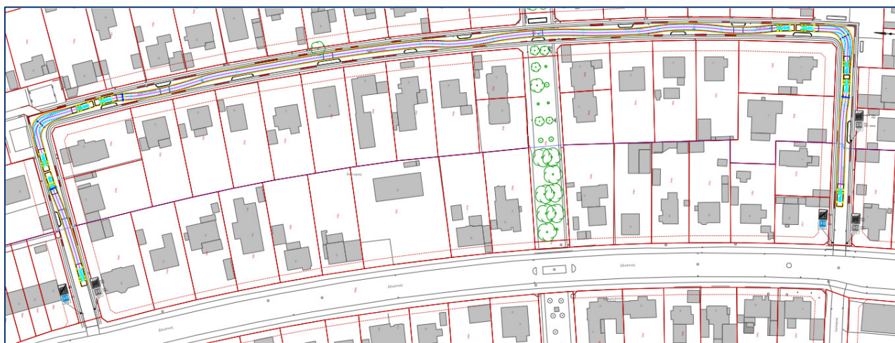
Figur 10 Figuren ovenover illustrer kørekurven for et 10 m renovationskøretøj på Kærstrupvej.
