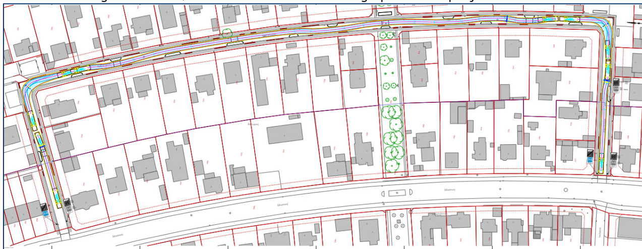
Figur 9 Figuren ovenover illustrer kørekurven for en 12 m lastvogn på Kærstrupvej.
